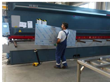
Tomáš Bobek – operátor hydraulických tabulových nůžek Durma při přípravě materiálů pro stříhání nerezí.
